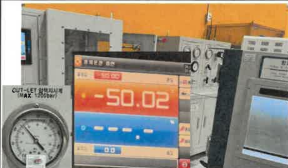
Test Pressure : 455 Bar, Temperature : -50℃
